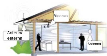
**Mono Plus** risolve i problemi legati alla qualità del segnale in quanto cattura le emissioni radio della stazione base dell'operatore telefonico e le replica, rafforzate, in ambito locale.
