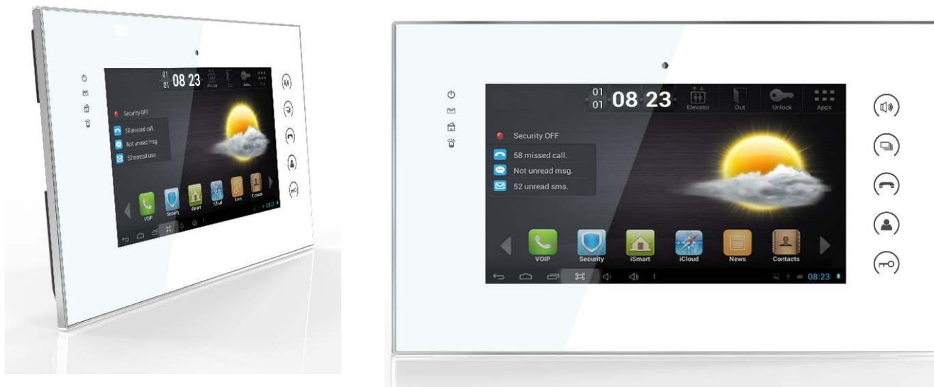
Il monitor KIRO IP Domus 300 con protocollo TCP / IP SIP e Android 4.2.2 è una unità di domotica e telefono SIP. Touch screen da 7 "capacitivo LCD con retroilluminazione a LED. Ideale da interno per essere utilizzato con la serie di video-citotelefonii Kiro IP e Kiro IP Bold e altri video-citotelefonii a standard SIP. Programmabile da web. Comunicazioni a mani libere.
